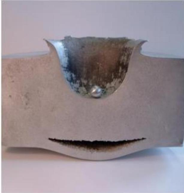
Impacto de uma esfera de 1.2 cm de diâmetro colidindo com um bloco de 10 cm de espessura a 6.8 km/s
